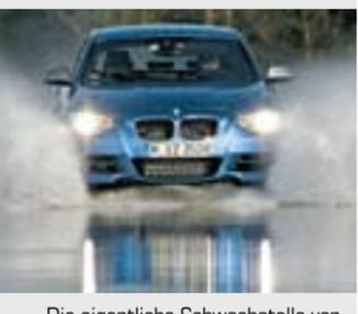
... Die eigentliche Schwachstelle von breiten Winterreifen. Je breiter der Reifen, desto schwerer lässt sich das Wasser unter der Lauffläche verdrängen. Sommerreifen versuchen, mit breiten Profilrillen Abhilfe zu schaffen. Bei Winterreifen ist das aufgrund der speziellen Profilstruktur und der weichen Gummimischung nicht möglich. Gut, dass es elektronische Helferlein wie ESP und DSC gibt...
