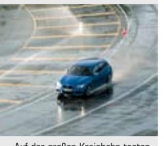
... Auf der großen Kreisbahn testen wir den Nässegrip unserer Kandidaten bei konstantem Kurvenradius. Wie in einer endlosen Kurve versuchen wir dabei, das Fahrzeug möglichst schnell an der Haftgrenze der Reifen um den Kreis zu bewegen. Die schnellste Rundenzeit fährt unser Testwagen auf dem Nokian WR A3; der Star Performer aus China kommt vorzeitig ins Untersteuern.
