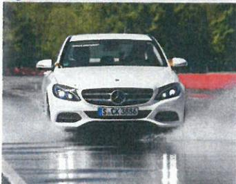
... Eigentlich sollte aufgrund seiner stabilen Profilstruktur mit extrabreiten Hauptprofilrillen der Sommerreifen die beste Wasser-Verdrängung generieren. Doch bei unseren Aquaplaningtests mit einer Wassertiefe von etwa sieben Millimetern liegen die Winterkandidaten von Dunlop und Pirelli mit den größten Sicherheitsreserven vorn.
