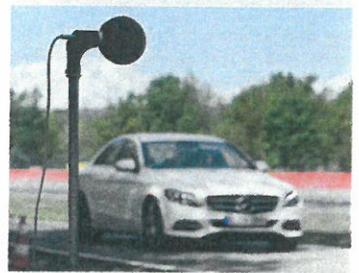
... Das Vorbeifahrgeräusch wird von außen und mit abgeschaltetem Motor gemessen. Den geringsten Ausschlag der Messinstrumente verzeichnen wir bei der Vorbeifahrt der C-Klasse auf dem Vredestein-Produkt. Knapp zwei Dezibel mehr messen wir für den Continental. Im Innenraum des Testwagens sind solche Unterschiede nicht zu bemerken.
